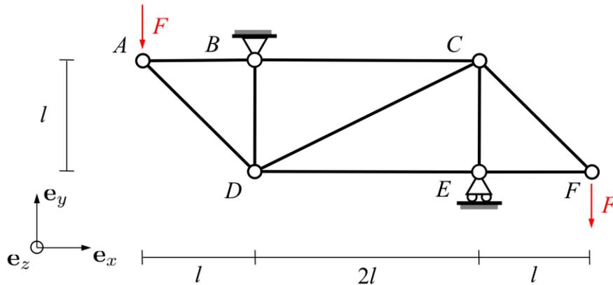
Wie gross ist die Stabkraft  $CD$ ? Handelt es sich um einen Zug- (positiver Wert) oder Druckstab (negativer Wert)?
