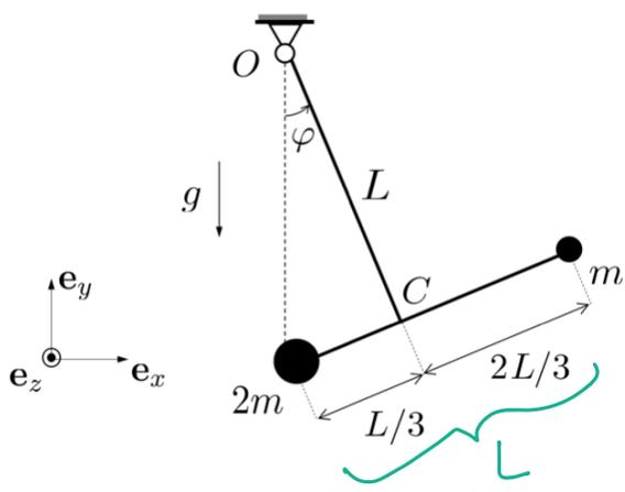
Unter welchem Winkel  $\varphi$  befindet sich das System in Ruhe?
