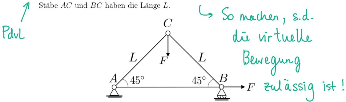
Wie gross ist die Stabkraft im Stab BC (positiv für einen Zugstab, negativ für einen Druckstab)?
