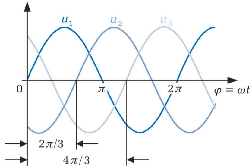
Fliessen drei  $120^\circ$  phasenverschobene Ströme durch drei  $120^\circ$  räumlich versetzte Spulen, ergibt die Überlagerung der Teilfelder ein räumlich umlaufendes Drehfeld.
