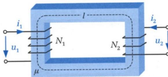
Abbildung 6.39: Übertrager mit Primär- und Sekundärwicklung
