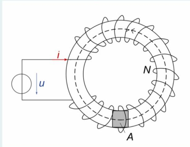
Welche Windungszahl  $N$  darf die Spule maximal haben um nicht zu saturieren?
