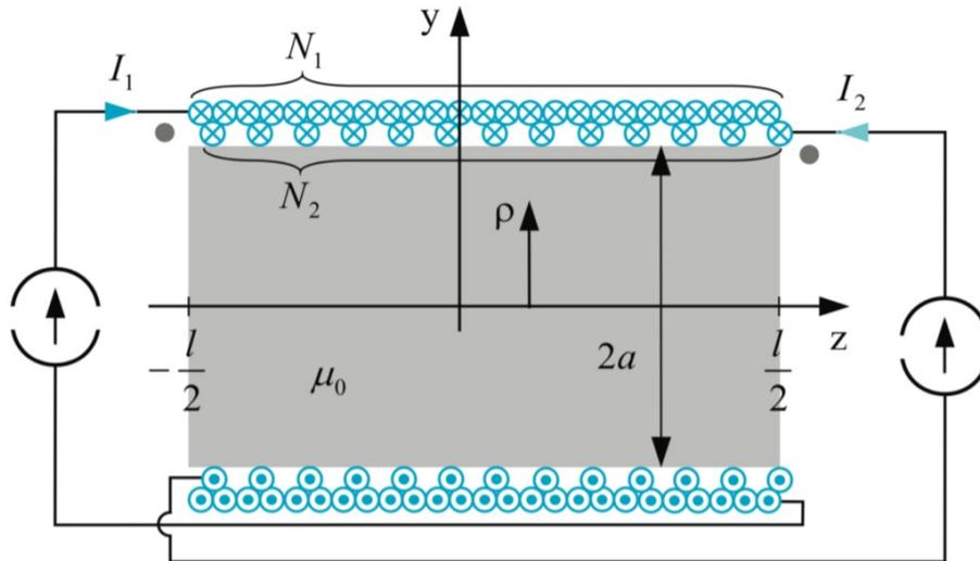
Abbildung 1: Zylinderförmiger Übertrager
