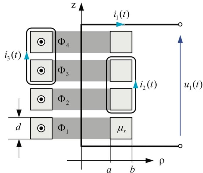
Abbildung 1: Induktivität aus vier Ringkernen
