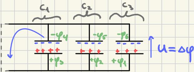
Bei einer Parallelschaltung von Kapazitäten addieren sich diese zu einer Gesamtkapazität:
