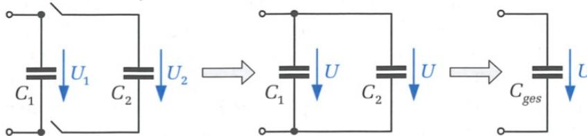
Abbildung 1.42: Zusammenschaltung der Kondensatoren
