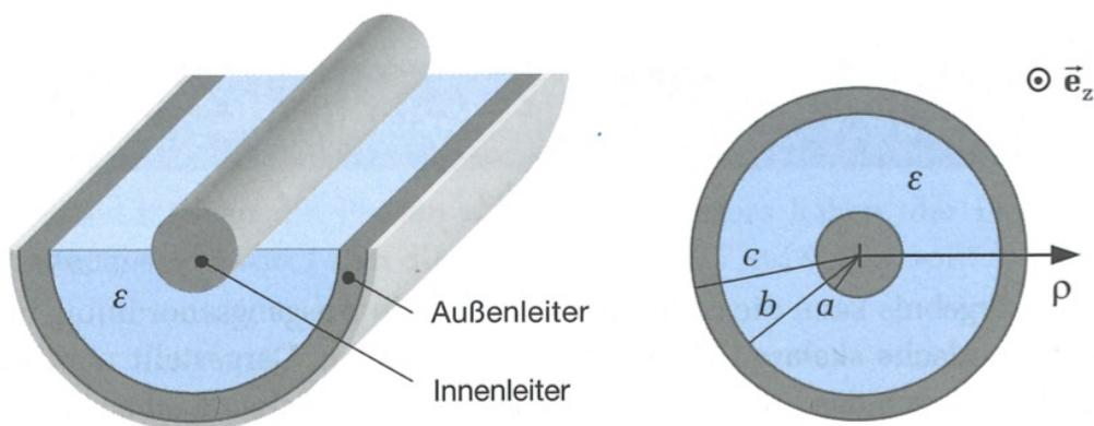
Abbildung 1.33: Querschnitt durch die Koaxialleitung
