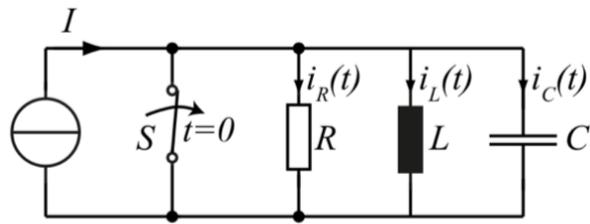
Abbildung 3: Parallelschwingkreis
