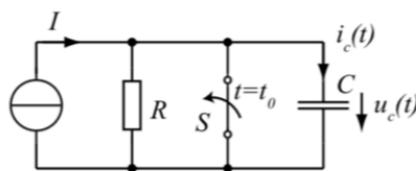
Abbildung 1: Netzwerk mit kapazitiver Last
