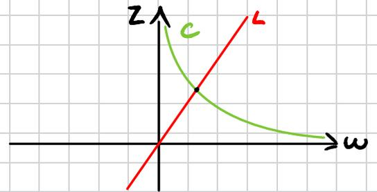
Was passiert **unter** / **drüber** der Resonanzfrequenz?
